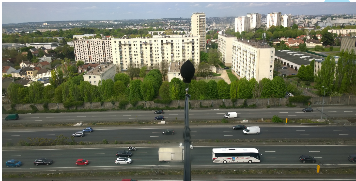
Mesure de bruit réalisée par Bruitparif en façade du 15ème étage d'un immeuble de la rue Peruenche, qui jouxte l'autoroute A6 à L'Haÿ-les-Roses.
